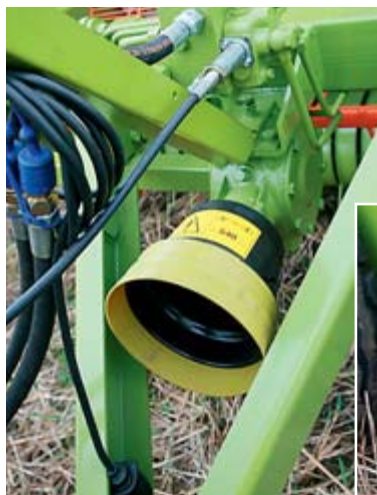
Редуктор и гидрораспределитель
